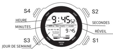
**S1 (RESET)** : Bouton de conversion • **S2 (START)** : Bouton d'ajustement • **S3 (MODE)** : Bouton de mode • **S4 (LIGHT)** : Éclairage
